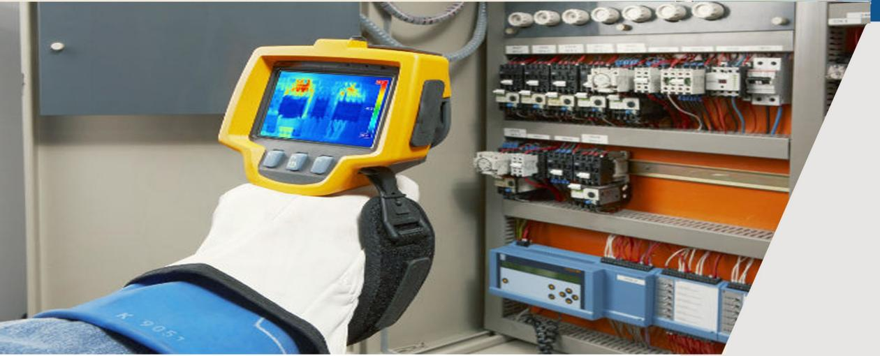
Esta Guía analiza las diferentes técnicas de mantenimiento basado en condición, como el análisis de vibraciones, la termografía, la boroscopia, el análisis de aceites y de humos, el diagnóstico por ultrasonidos, etc., así como la implantación de esta sistemática en una organización, para formar auténticos expertos en la materia y facilitar así la implantación de esta estrategia de mantenimiento en cualquier clase de instalación.
