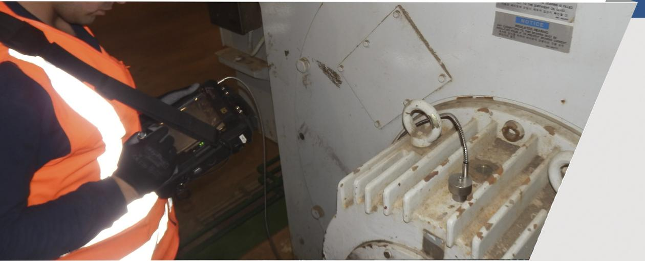
El mantenimiento predictivo es una técnica de mantenimiento consistente en 'predecir' el estado de un equipo basándose en una variable física o química. La temperatura, la vibración, el aspecto físico, la composición química de un fluido o el comportamiento ante un estímulo externo pueden ser utilizados para diagnosticar un equipo predecir cuando fallará y anticiparse al fallo interviniendo en él antes de que lo haga.
